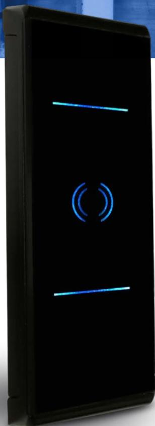
ZA1 è collegabile come lettore esterno dei terminali o controller Zucchetti che supportano il protocollo SPP. ZA1 è equipaggiato con unità di lettura RFID multistandard 125kHz/ 13.56MHz/ BLE a singola antenna.
